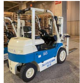
リチウムイオンバッテリーを搭載した電動フォークリフト
